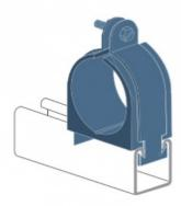
技术参数: 卡夹材质: 冷机低碳钢 表面处理: 电镀锌处理: 如需热镀锌、 这克罗或不铸钢材料, 订货时需说明 村套材质: 热塑性弹性体 场用温度: ~60℃~+150℃
